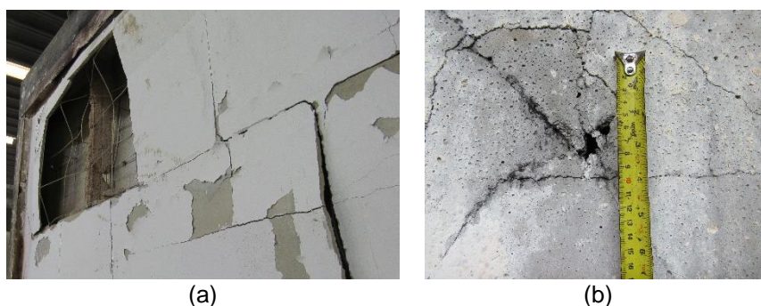
Figura 9 – Aspecto pós-ensaio, (a) degradação de blocos na face exposta e (b) trincas na face não exposta
